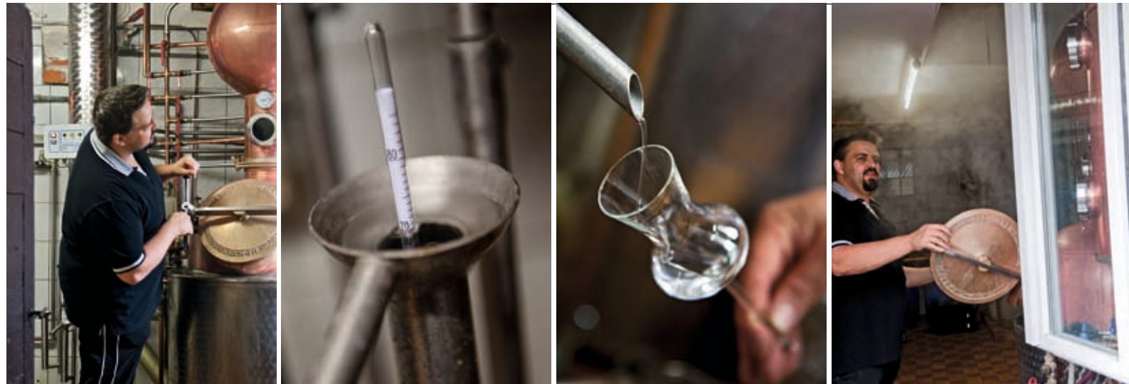
GUT DING WILL WEILE HABEN Der Brenner kontrolliert die Kessel-Temperatur. Sie muss während des Brennvorgangs möglichst konstant bleiben. Zeigt dann der Alkoholmeter sinkenden Gehalt an, beginnt der Nachlauf. Er muss sauber vom „Herzstück“ abgetrennt werden. Jede Probe ist eine spannende Momentaufnahme des entstehenden Edelbrandes. Kommt kein Destillat mehr aus dem Rohr, wird der Kessel von Neuem befüllt
